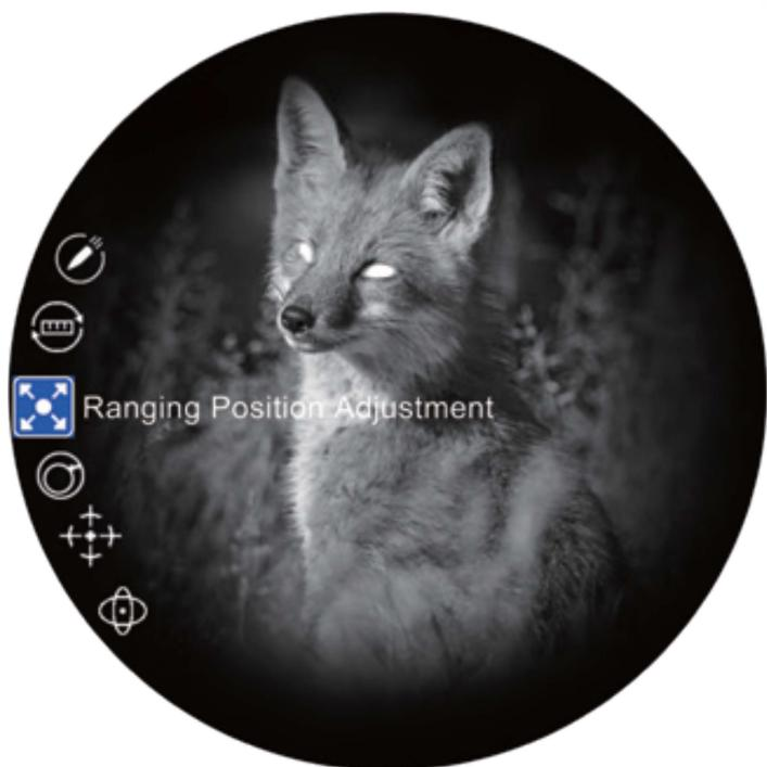
4. Поверните ручку, чтобы отрегулировать значения «X» и «Y». Положение лазерного дальномера (LRF) изменится соответственно. Совместите положение LRF с белым световым индикатором.
